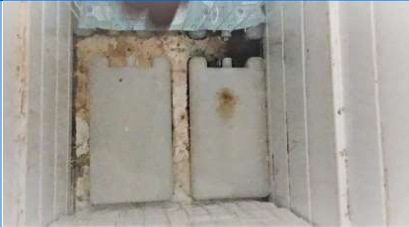
1. Condensation et moisissures dans le réfrigérateur de la DRAS
