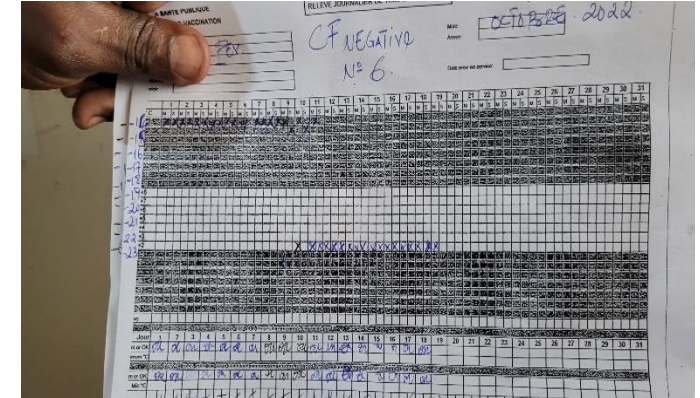
Illustration 3 : relevé des températures d’octobre 2022 de la chambre froide n°6 faisant ressortir la réparation de la ventilation et retour à des températures dans les normes
